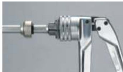
Fig. 16-2 Lărgire cu o singură mișcare a capătului de țevă
