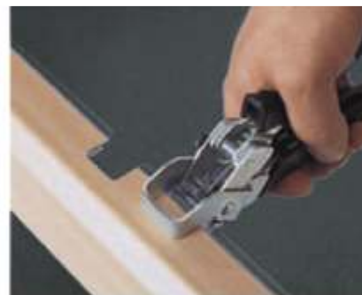
Fig. 20-25 Decuparea părții superioare a canalului plintei
